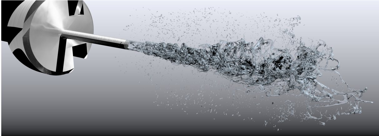
FIGURE 1.1 – L’atomisation d’un jet d’eau dans l’air - L’injection se fait de gauche à droite . La fragmentation du jet met en présence différentes tailles de l’interface, allant des grosses structures aux gouttes les plus fines en passant par les échelles intermédiaires [112].
