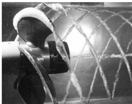
(c) La cavitation dans les hélices de bateaux. Ce phénomène s'accompagne de la formation de bulles de vapeur à l'intérieur du liquide dans les zones de basse pression qui se produisent dans les endroits où le liquide a été accéléré à des vitesses élevées.
