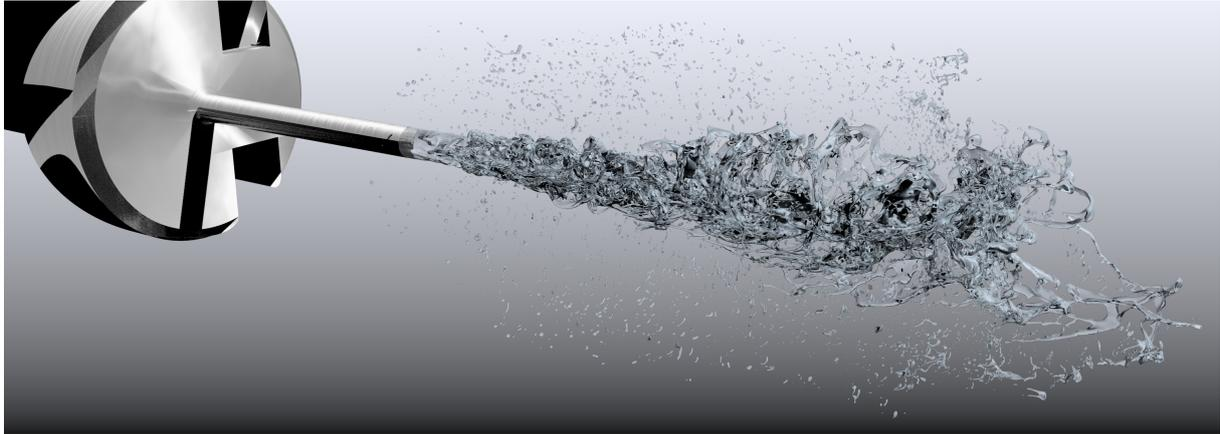
FIGURE 1.1 – L’atomisation d’un jet d’eau dans l’air - L’injection se fait de gauche à droite . La fragmentation du jet met en présence différentes tailles de l’interface, allant des grosses structures aux gouttes les plus fines en passant par les échelles intermédiaires [112].
