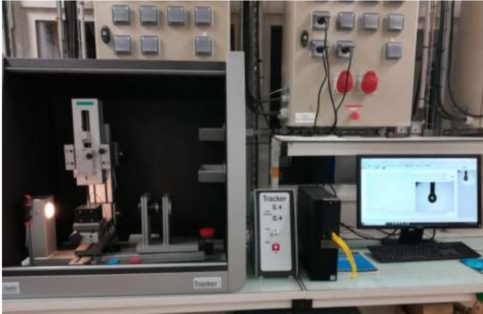
Figure II-5 : Tensiomètre à goutte automatisé utilisé pour la mesure de la tension de surface
