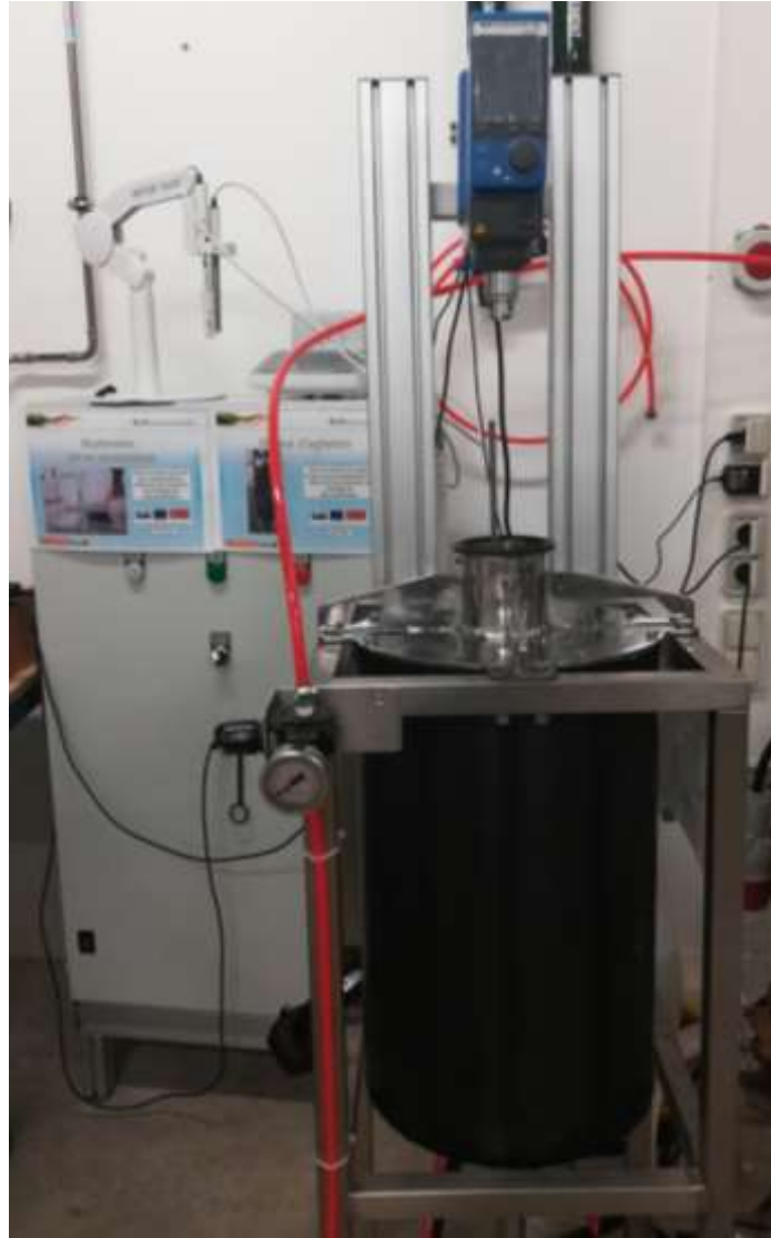
Figure II-1 : Montage de la colonne à ultrasons en mode batch
