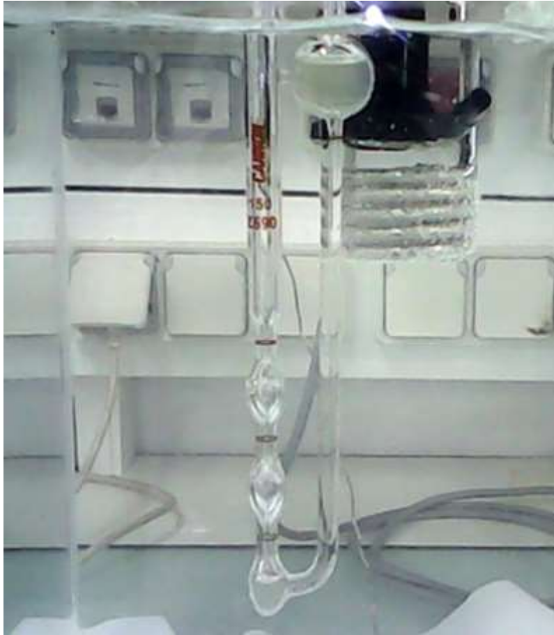
Figure II-4 : Dispositif de mesure de la viscosité cinématique avec un viscosimètre dans un bain à 40°C
