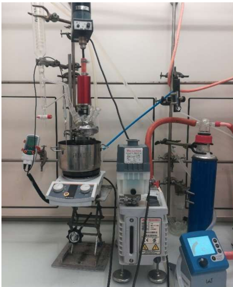
Figure IV-1 : Photographie du montage utilisé pour la synthèse des esters de sucre par transestérification en catalyse basique en milieu DES.
