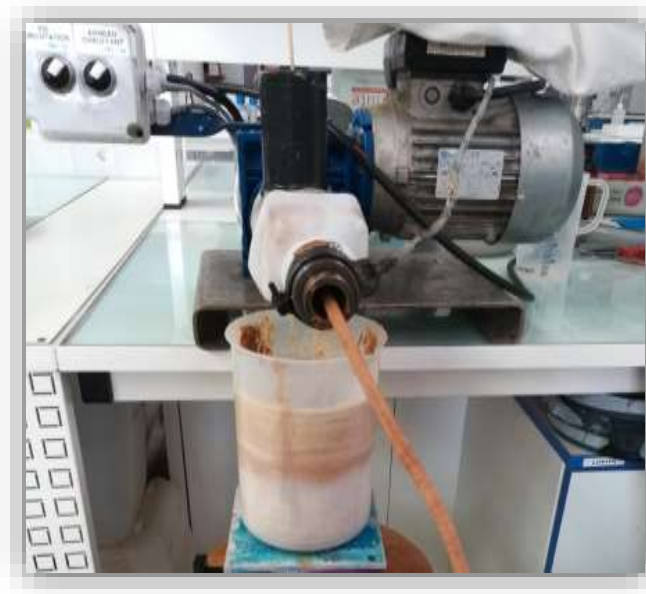
Figure II-2 : Presse monovis utilisée pour le pressage des graines
