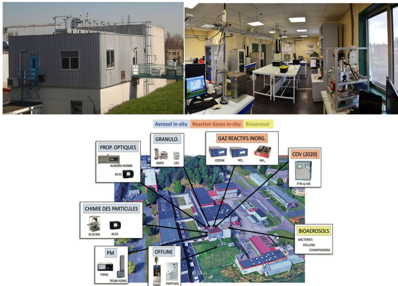
Figure II.2: Vues extérieure (en haut, à gauche) et intérieure (en haut, à droite) de la station d'observation in-situ du SIRTA z5. Récapitulatif des mesures effectuées au SIRTA (en bas). Crédit images : J-E Petit
