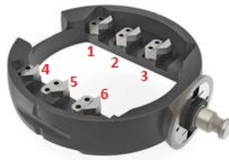
Figure V.2 : Numérotation des emplacements du chargeur de la MOCN D'après document commercial
