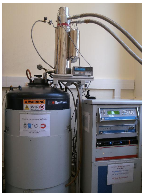
Figure 2.20 – Appareil de mesure de la résistivité électrique par la technique PPMS [Orn21]
