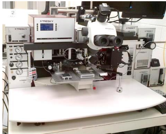
Figure 2.10 - Machine pour la consolidation par Die-bonder (modèle T3000-FC3 de Tresky)
