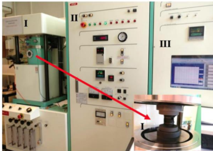
Figure 2.9 - Machine pour le frittage par SPS (modèle Dr. Sinter LAB Series SPS-515S) [Pil20]
