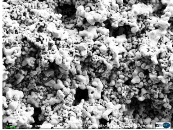
Figure 5.10 - Image MEB après déliantage de la pâte H2 à 130°C pendant 10 min
