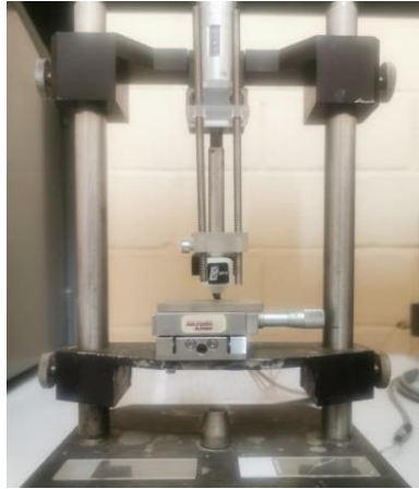
Figure 2.19 - Appareil de mesure de la résistivité électrique par la technique des 4 points
