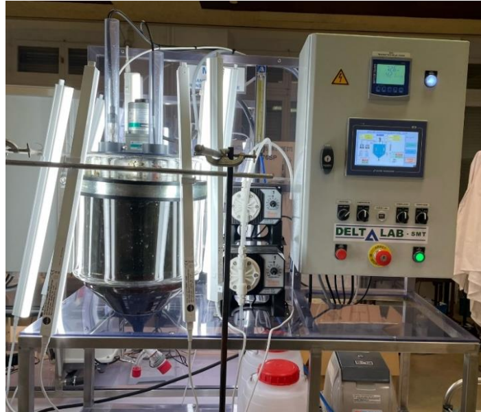
Figure 44. Photo du photobioréacteur à double enveloppe
