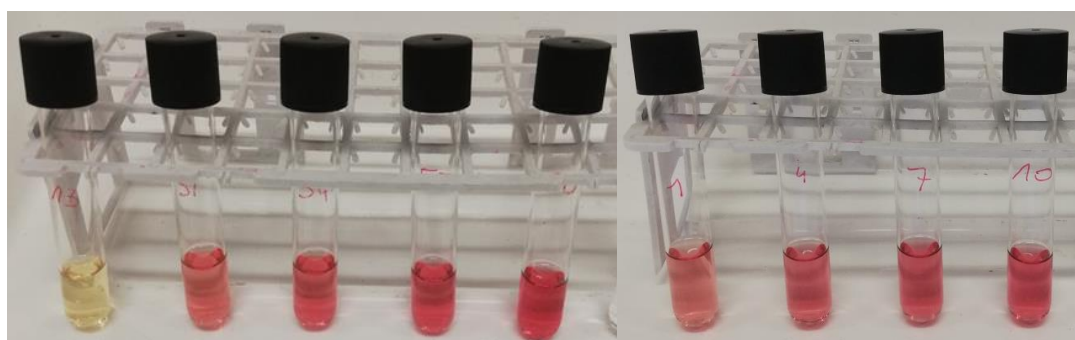
Figure 59. Etalonnage avec 0, 27, 40, 50, 70 µL d'acide oléique (gauche) et 30, 40, 50, 70 µL d'huile de colza (droite)
