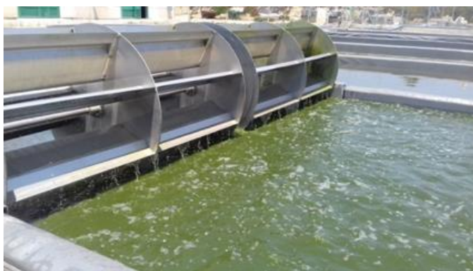
Figure 27. Exemple de roue à aubes (Pappalardo, 2018)
