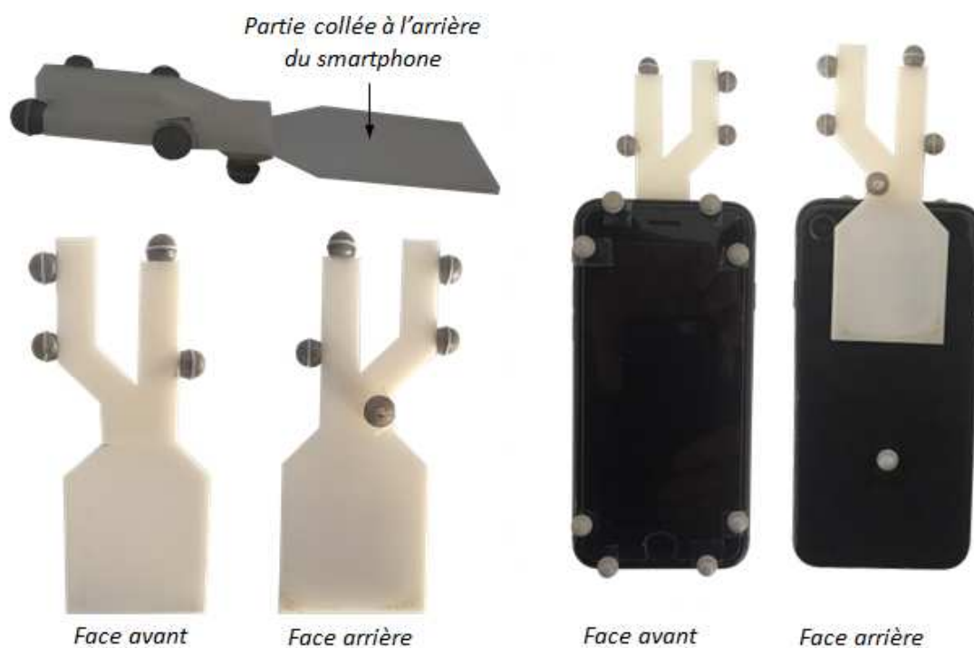
Figure II.10 : Illustration de la pièce en résine équipée de ses 5 marqueurs conçue spécialement pour la réalisation du protocole expérimental seule (à gauche) et attachée au smartphone (à droite) également équipé de ses 14 marqueurs (les marqueurs sur le smartphone ne sont présents que pour la première acquisition statique).
