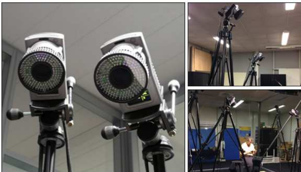
Figure II.7 : Illustration des caméras Oqus 400 de la marque Qualisys (à gauche) et répartition autour de l'espace de mesure (à droite).
