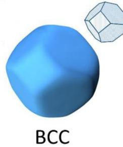
Figure 26 : polyèdre formé par la déformation de la couche de ligand dans une structure type BCC<sup>51</sup>.
