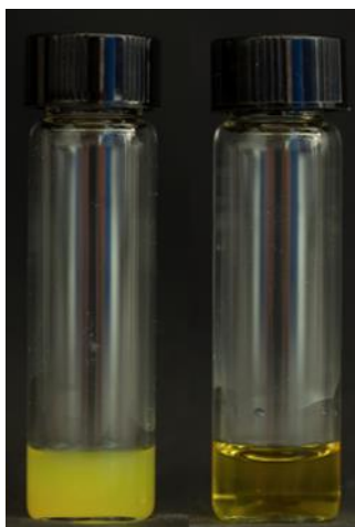
Figure 8.8- Photographies d'une solution contenant un mélange ATP/AzoDiGua avant (gauche) et après ajout d'une solution de 2 mM d' \alpha -cyclodextrine (droite).
