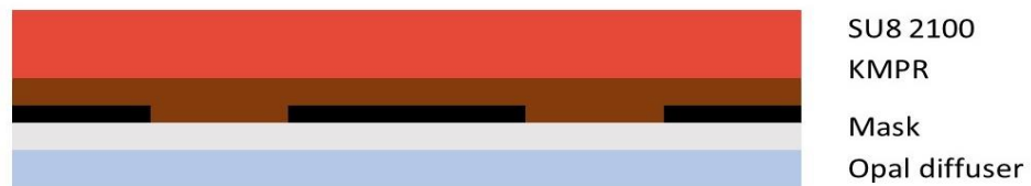
Figure 58 : Etape de fixation d'un diffuseur en opale sur la face arrière du masque, après le dépôt de la résine SU8 2100 par enduction centrifuge sur la résine KMPR.
