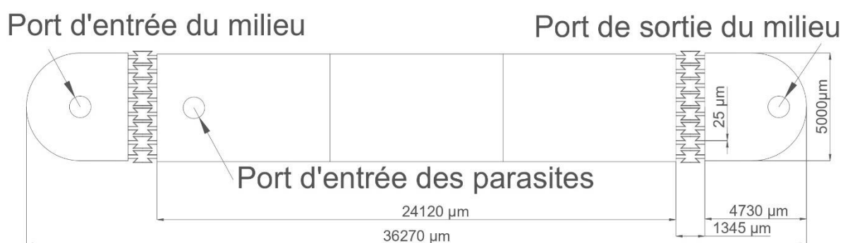
Figure 109 : Géométrie de la puce N°8. Cette dernière puce microfluidique réversible en flux est une modification du circuit N°6 (Figure 94). Ce circuit est un monocanal de 36.27 µm de long pour 5 mm de large, munie de deux arrondis de 500 µm de diamètre. Deux grilles anti-échappement ont été placées à 4.73 mm des deux arrondis de la puce. Chacune d'elles dispose de 16 canaux de 25 µm de large pour permettre la circulation du milieu de culture. Sur cette puce, un port d'introduction des parasites a été disposé dans la partie centrale, au plus proche de l'une des deux grilles, puis des entrée (port d'entrée du milieu) et sortie (port de sortie du milieu) ont été positionnés sur les parties extérieures du dispositif.
