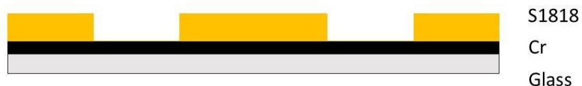
Figure 44 : Etape de développement de la résine par du développeur MF26 afin de libérer le chrome.
