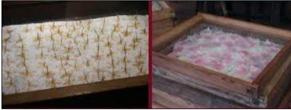
Figure 29: Schéma de l'enfleurage à froid
