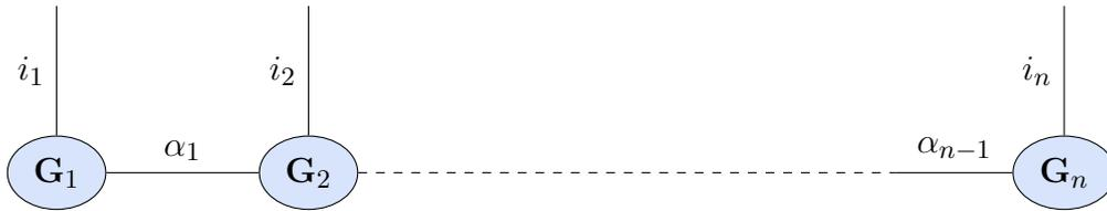
FIGURE 4.2 – Représentation Tensor network de type Tenseur Train
