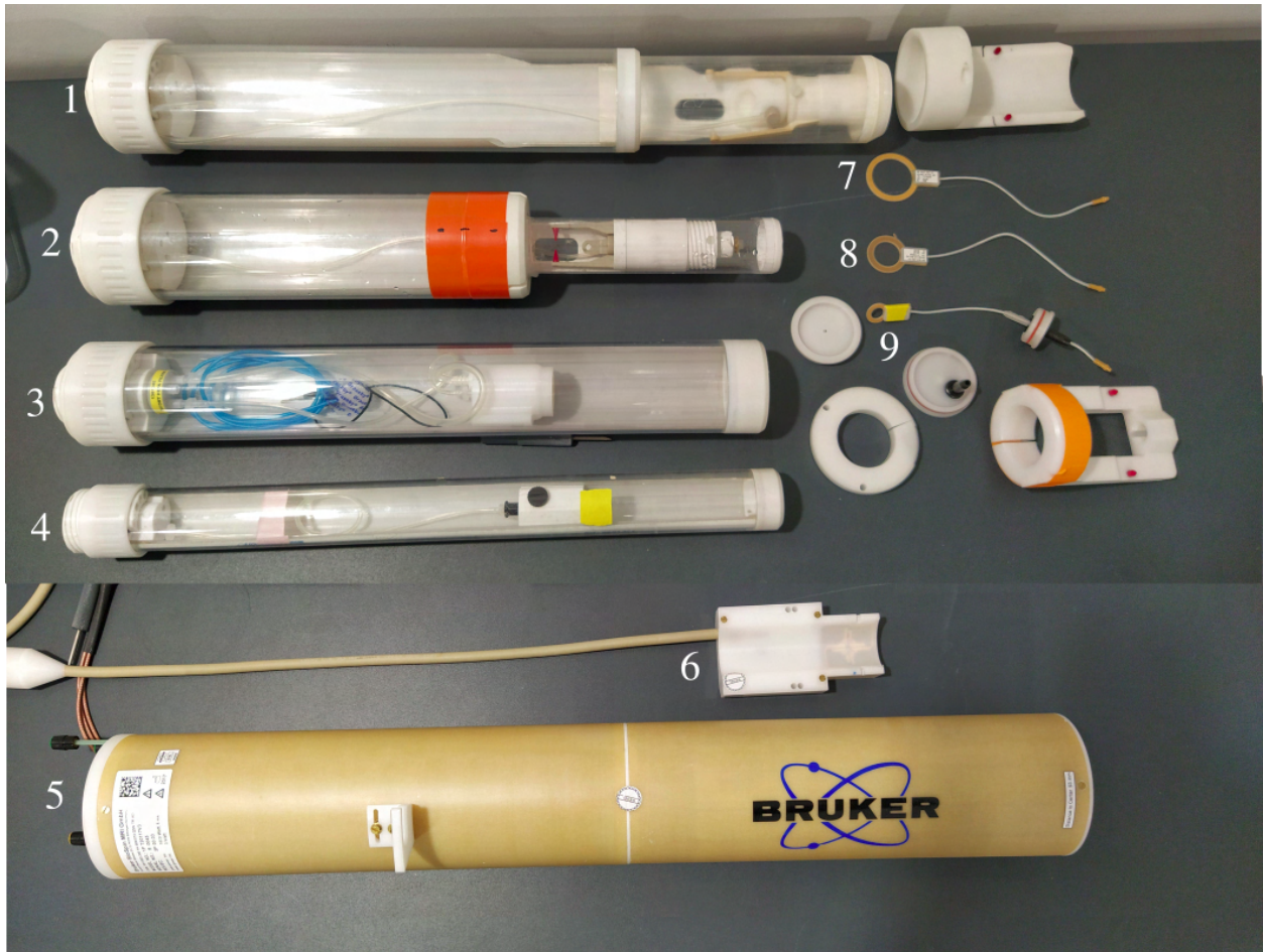
FIGURE 2.14 – Antennes et cellules disponibles sur l'IRM préclinique 7T du service ENI-CREFRE. (1) Cellule marmouset, (2) et (3) Cellules rat, (4) Cellule souris, (5) Antenne volumique émission/réception 72 mm, (6) Antenne surfacique 2x2 éléments tête rat, (7), (8) et (9) Antennes surfaciques de diamètre 30, 20 et 10 mm, respectivement.
