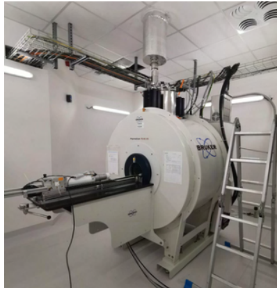
FIGURE 2.13 – Appareil IRM préclinique utilisé lors de ces travaux de thèse : Biospec 70/16 (Bruker, Ettlingen, Germany).
