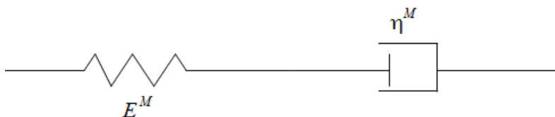
FIGURE 1.5: Modèle d'élasticité de Maxwell. Un ressort et un amortisseur en série.
