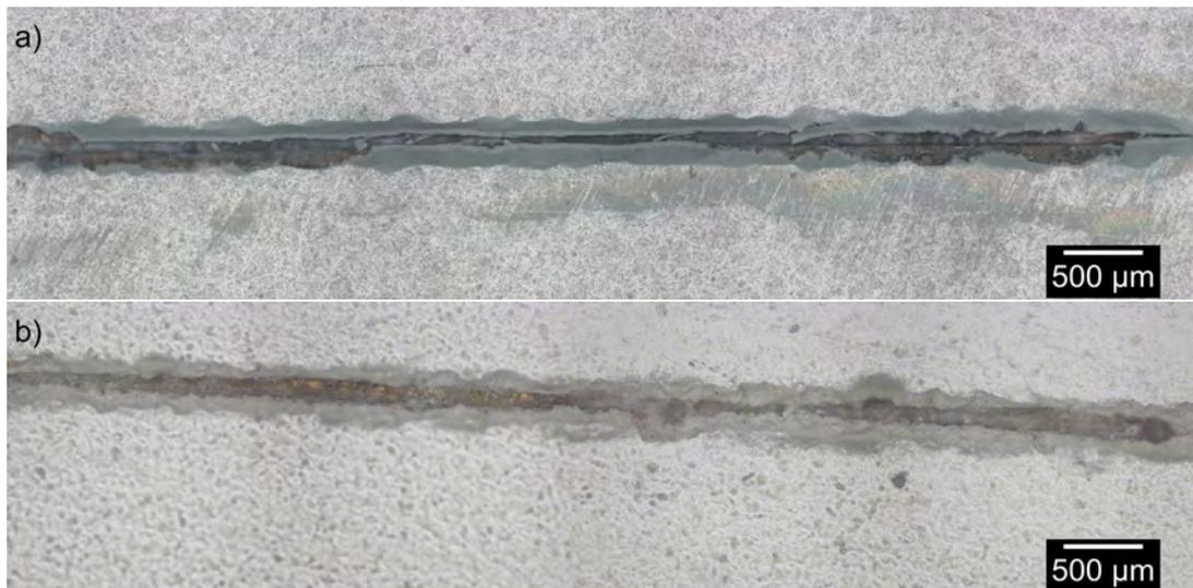
**FIGURE V.12** – Micrographies optiques de la rayure après 168 h d'immersion en milieu  $\text{Na}_2\text{SO}_4$   $10^{-3}$  M pour l'alliage WE43 + CEP et revêtu par : (a) le primaire NCC, (b) le primaire HSC.
