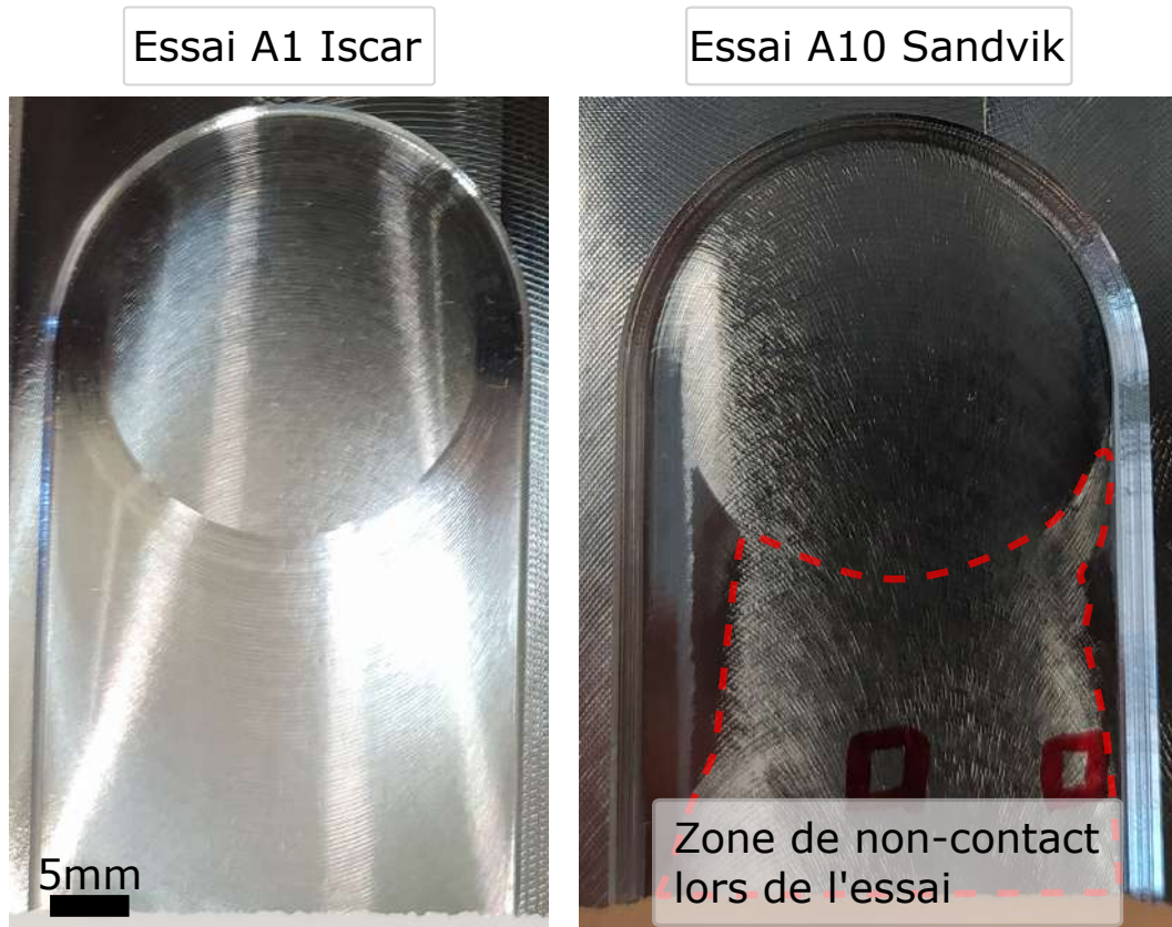
Figure 3.5 – Surfaces usinées par l'outil Iscar à gauche et par l'outil Sandvik à droite.
