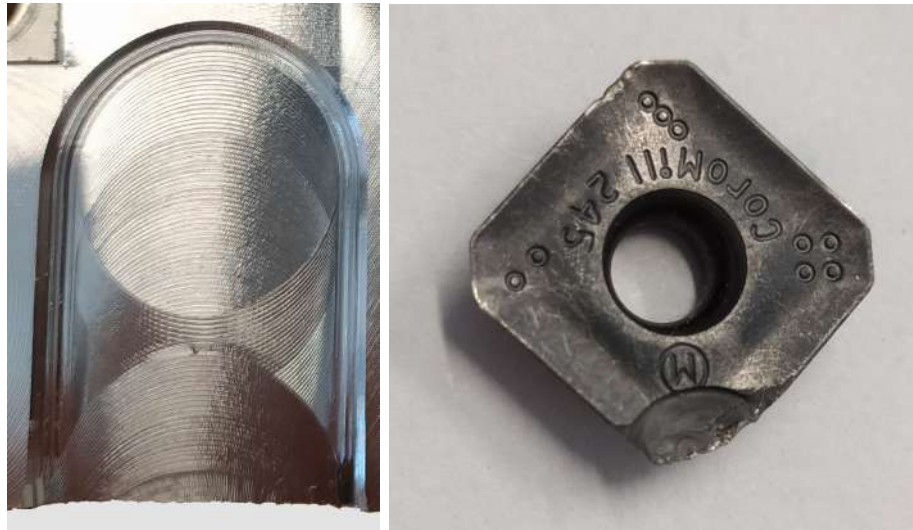
Figure 3.2 – À gauche, essai A15 pour l'outil Sandvik. À droite, plaquette Sandvik après l'essai.
