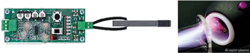
Figure 1.19. Dispositif de commande du produit PiezoBrush PZ2 (gauche) et plasma généré à l'extrémité du secondaire du transformateur (droite) [84]
