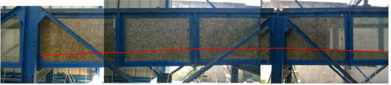
Figure I.3.2 : Expérience avec des cailloux de diamètre moyen  $d=1$  cm et un débit  $Q=4l/s$
