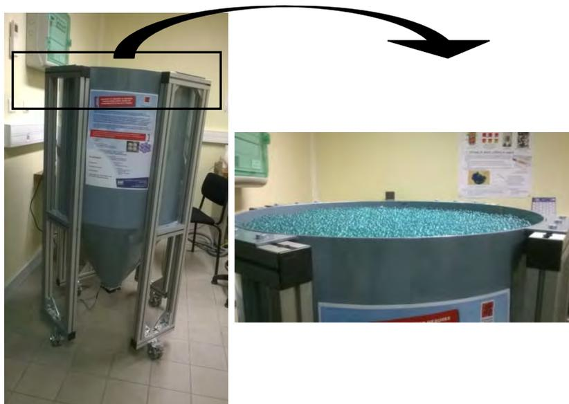
Figure I.2.13 : Photos du grand perméamètre de l'IMFT
