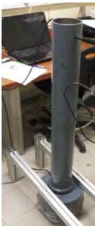
Figure I.2.14 : Perméamètre à petite section de l'IMFT
