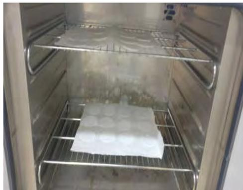
Figure II.3.19 : Séchage des filtres avant utilisation
