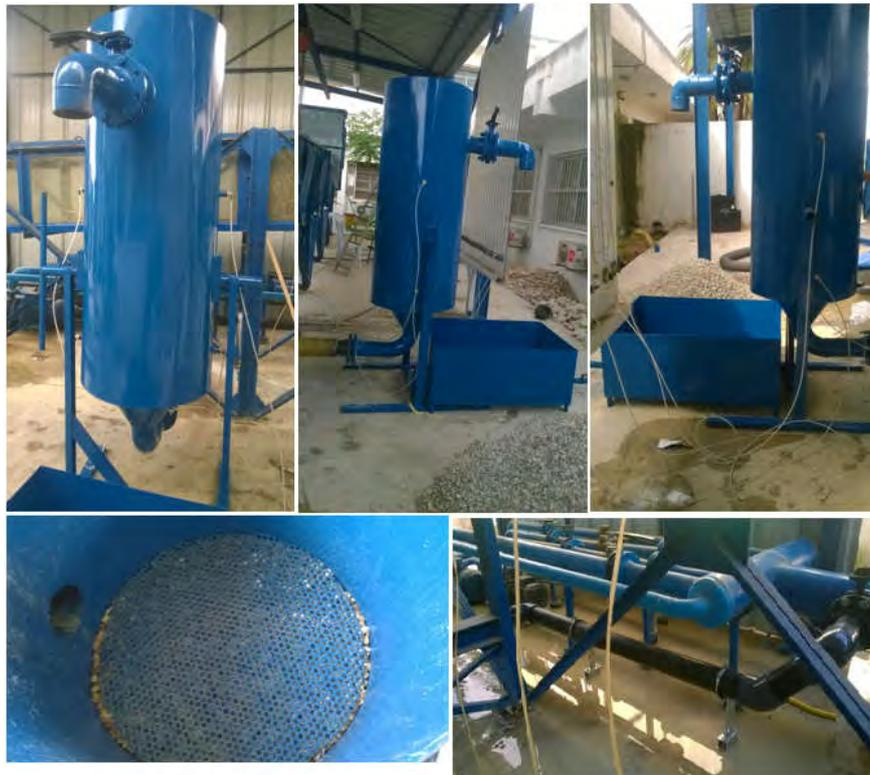
Figure I.2.12 : Photos du perméamètre conçu à l'INAT
