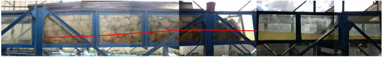
Figure I.3.13 : Expérience avec des cailloux de diamètre moyen  $d=15$  cm et un débit  $Q=12$  l/s
