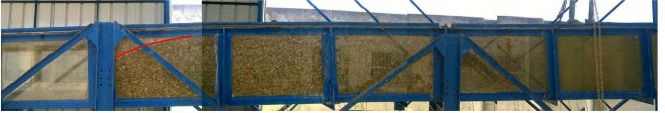
Figure I.3.7 : Expérience avec des cailloux de diamètre moyen  $d=1$  cm et un débit  $Q=18$  l/s
