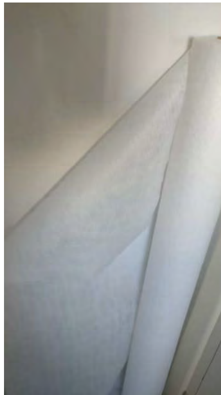
Figure II.2.1 : photo du géotextile de 150g/m 2 utilisé
