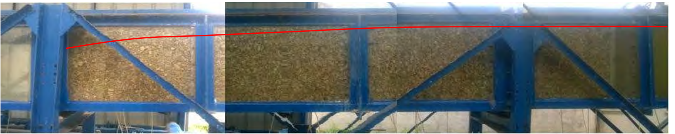
Figure I.3.4 : Expérience avec des cailloux de diamètre moyen d=1 cm et un débit Q=12l/s
