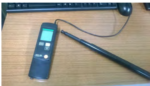
Figure I.2.16 : Anémomètre a fil chaud utilisé pour la mesure de la vitesse d'écoulement
