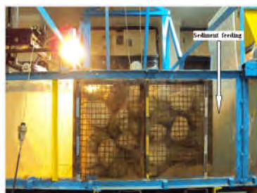
Figure II.1.4 : Le barrage en enrochement du laboratoire et l'alimentation en sédiments durant l'essai
