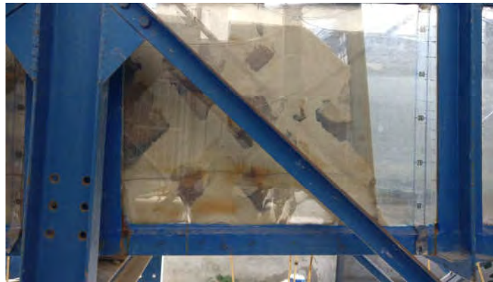
Figure II.3 17 : Photo de colmatage de l'entrée de milieu poreux (50cm) avec du sable blanc
