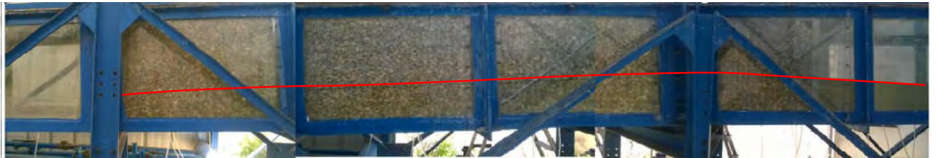
Figure I.3.3 : Expérience avec des cailloux de diamètre moyen d=1 cm et un débit Q=6l/s
