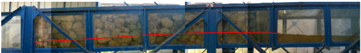
Figure I.3.12 : Expérience avec des cailloux de diamètre moyen d=15\text{ cm} et un débit Q=10\text{l/s}
