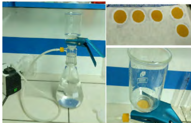
Figure II.3.20 : Photo du dispositif du filtrage
