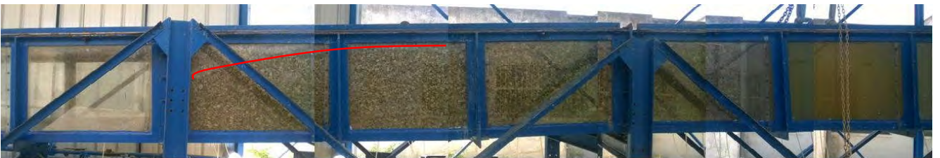
Figure I.3.6 : Expérience avec des cailloux de diamètre moyen d=1 cm et un débit Q=16l/s
