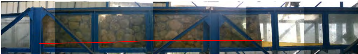
Figure I. 3.10 : Expérience avec des cailloux de diamètre moyen d=15\text{ cm} et un débit Q=6\text{l/s}
