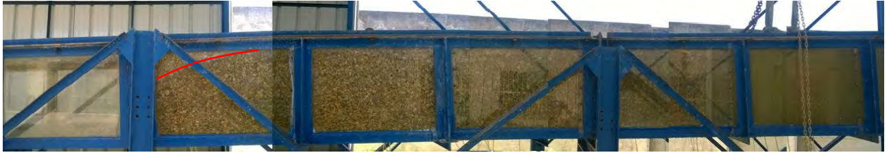
Figure I.3.7 : Expérience avec des cailloux de diamètre moyen d=1 cm et un débit Q=18 l/s
