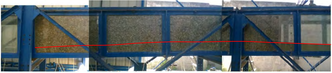
Figure I.3.2 : Expérience avec des cailloux de diamètre moyen d=1 cm et un débit Q=4l/s
