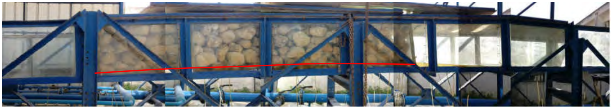
Figure I.3.9 : Expérience avec des cailloux de diamètre moyen d=15\text{ cm} et un débit Q=4\text{l/s}
