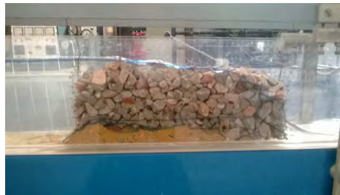
Effet de l'écoulement sur le fond sableux du transport milieu poreux (petit canal de l'INAT)
