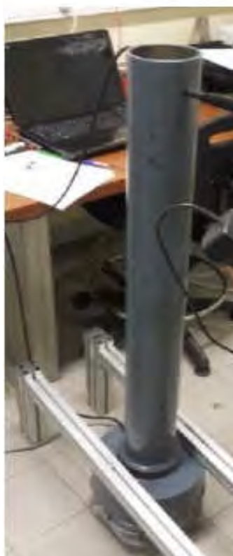
Figure I.2.14 : Perméamètre à petite section de l'IMFT
