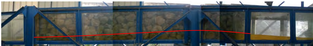
Figure I.3.11 : Expérience avec des cailloux de diamètre moyen d=15\text{ cm} et un débit Q=8\text{l/s}
