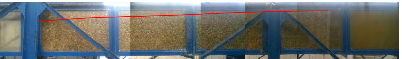
Figure I.3.5 : Expérience avec des cailloux de diamètre moyen d=1 cm et un débit Q=14l/s
