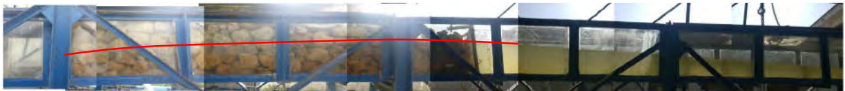
Figure I.3.14 : Expérience avec des cailloux de diamètre moyen d=15 cm et un débit Q=22 l/s
