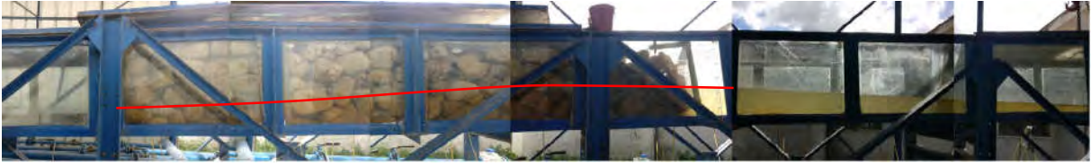
Figure I.3.13 : Expérience avec des cailloux de diamètre moyen d=15 cm et un débit Q=12 l/s
