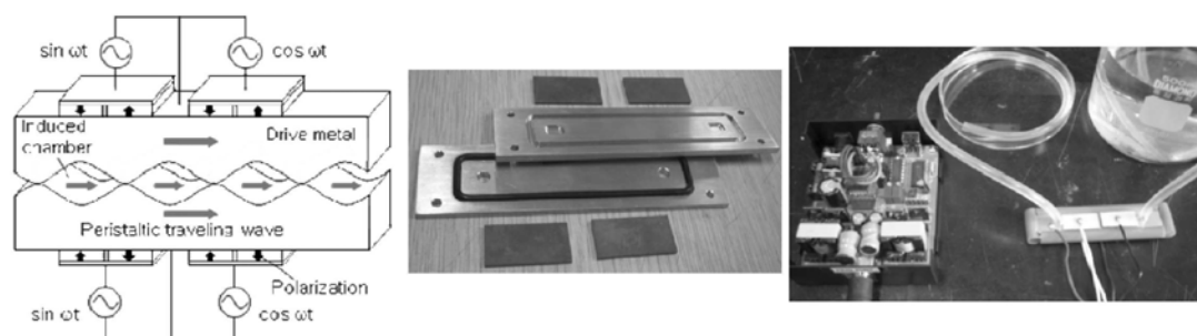
FIGURE 1.11 – Micropompe péristaltique à onde libre présentée par (Kim et al., 2009 [57])
