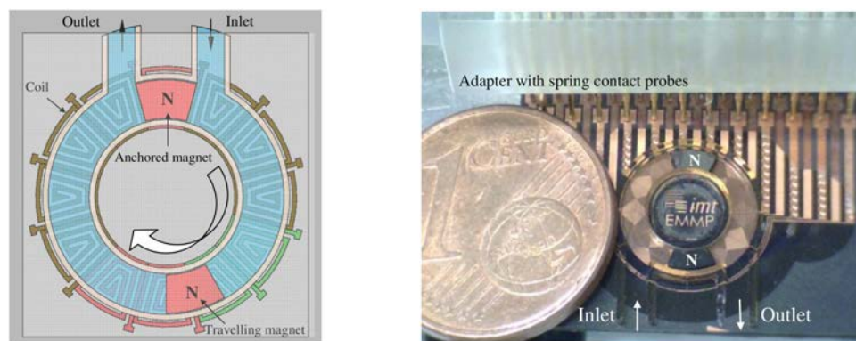
FIGURE 1.26 – Micropompe péristaltique électromagnétique à onde forcée continue (Al Halhouli et al., 2012 [78])
