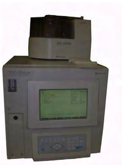
Photo 4 : Shimadzu TOC-5000 : oxydation thermique et détection infrarouge
