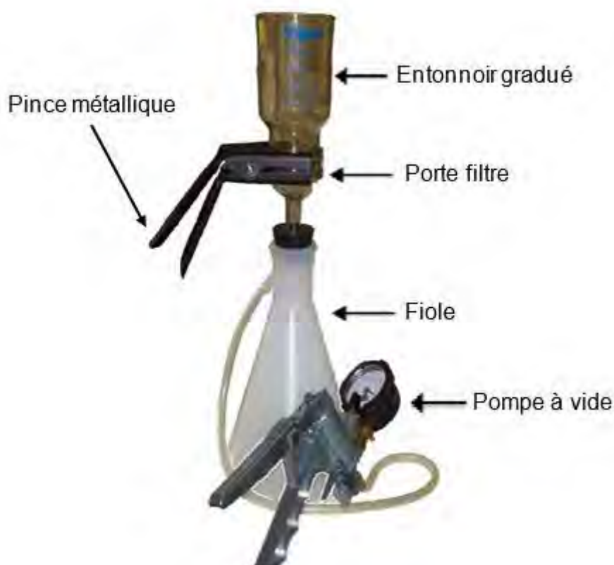
Figure 22 : Unité de filtration des eaux, Laboratoire MBE UJN Kankan
