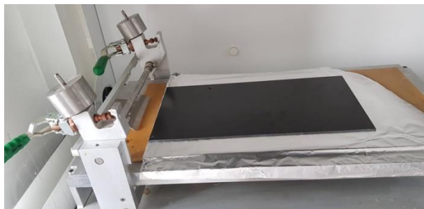
Figure 23 : Barcoater et réalisation d'un bicouche
