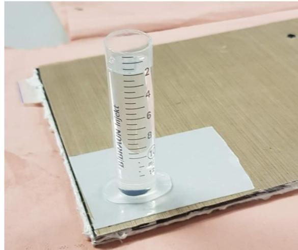
Figure 22 : Injection de la colle dans les assemblages
