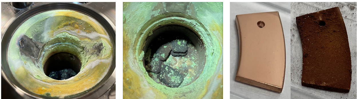
Figure 4.23 – Photos du réacteur à l'ouverture avec présence de précipités verts, jaunes et blancs côté vapeur (à gauche), des blocs de Fe_3O_{4(s)} + CuO_{(s)} au fond du réacteur (au milieu) et de la plaque de cuivre avant et après essai (à droite)
