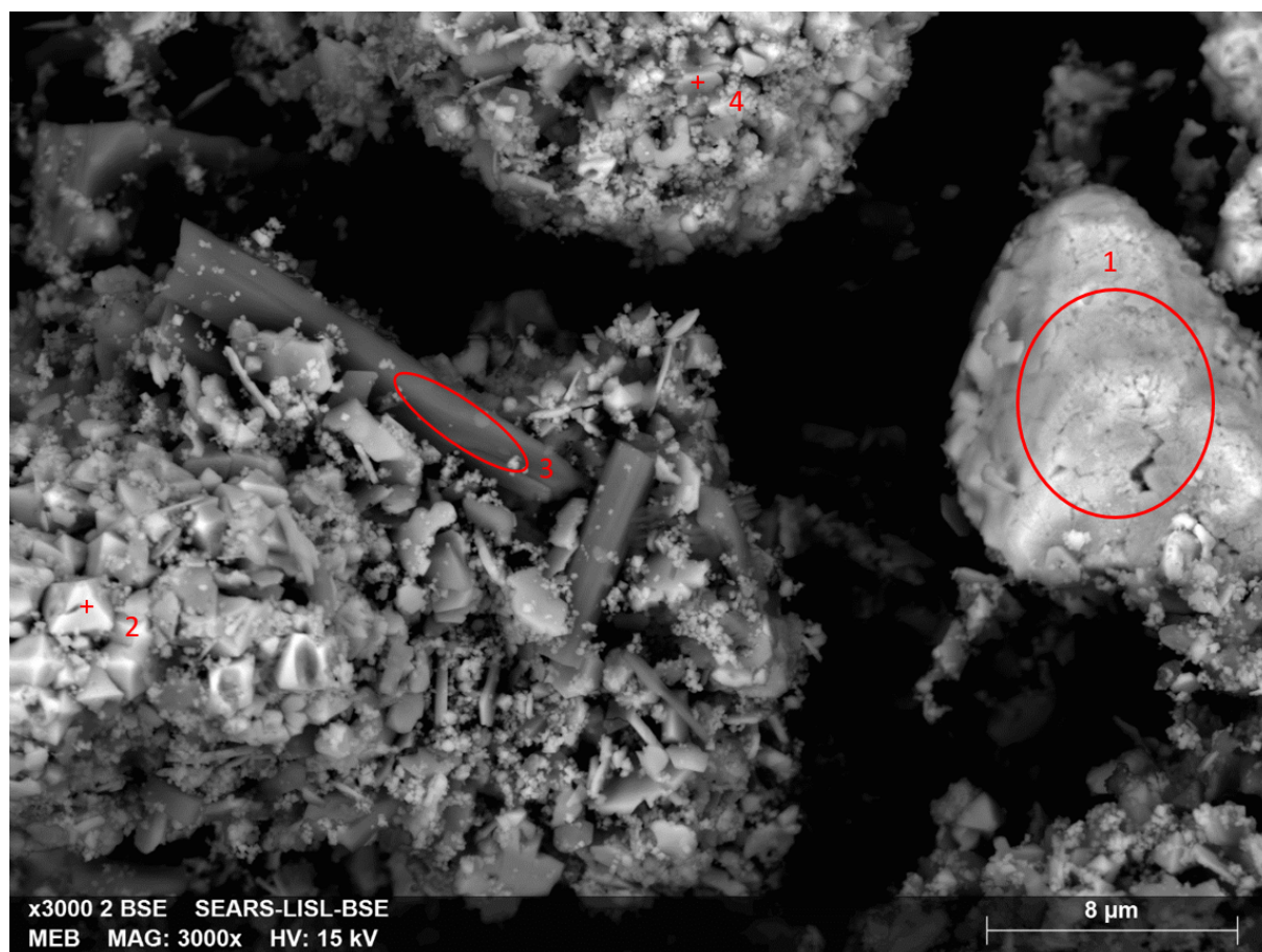
Figure C.11 – Photo de la zone analysée en EDS pour la poudre de \text{Fe}_3\text{O}_{4(s)} + \text{Cu}_2\text{O}_{(s)} après l'essai S_3
