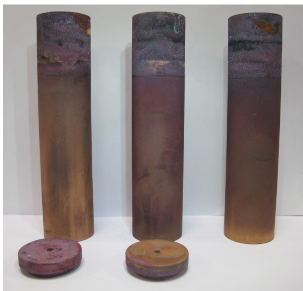
Figure 4.16 – Photo des tubes de cuivre après l'essai S2 en environnement aéré. Les cristaux rouge sombre sont majoritairement localisés sur la partie haute des tubes
