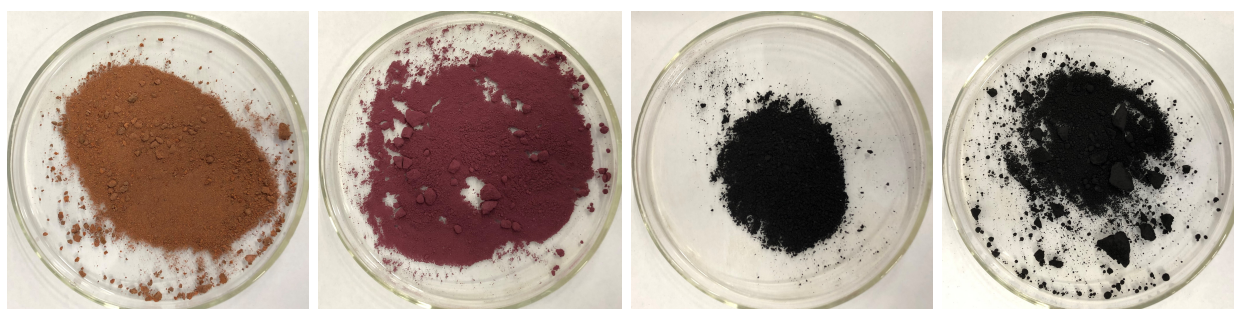
Figure C.2 – Poudres utilisées dans l'étude expérimentale, respectivement de gauche à droite : \text{Cu}_{(s)} , \text{Cu}_2\text{O}_{(s)} , \text{CuO}_{(s)} et \text{Fe}_3\text{O}_{4(s)}
