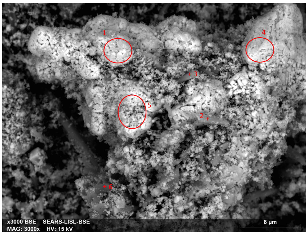
Figure C.10 – Photo de la zone analysée en EDS pour la poudre de \text{Fe}_3\text{O}_{4(s)} + \text{Cu}_{(s)} après l'essai S3
