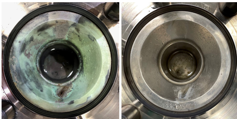
Figure 4.7 – Photos du réacteur à la fin des essais E1 (biphasique) (à gauche) et E2 (monophasique) (à droite) après ouverture
