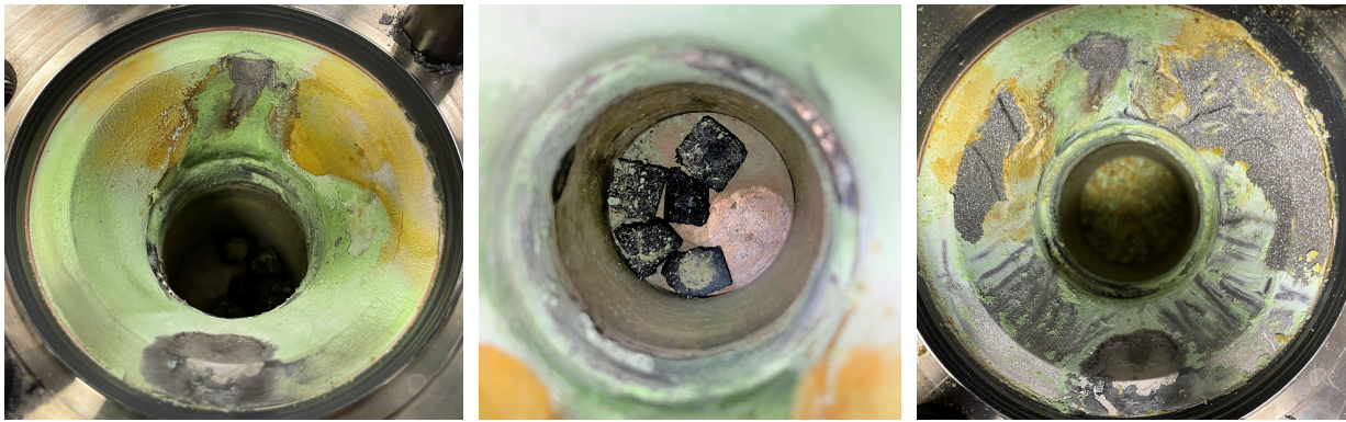
Figure 4.9 – Photos du réacteur à l'ouverture avec présence de précipités verts et jaunes côté vapeur (à gauche), des blocs de \text{Fe}_3\text{O}_{4(s)} au fond du réacteur (au milieu) et de l'aspect dégradé de la couche métallique de surface du réacteur (à droite) après l'essai E3
