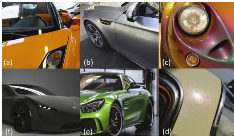
Figure 1.1 – Le secteur de l'automobile est le leader de l'innovation vis-à-vis de l'apparence. Les revêtements, aussi communément appelés « Car paint » étaient d'abord uniformes et brillants (a) avant de devenir métallisés dans les années 80 (b), goniochromatiques (c) et brillants (d) dans les années 90, puis plus récemment satinés (e) voir mats (f) dans certains cas. Image provenant de [1].
