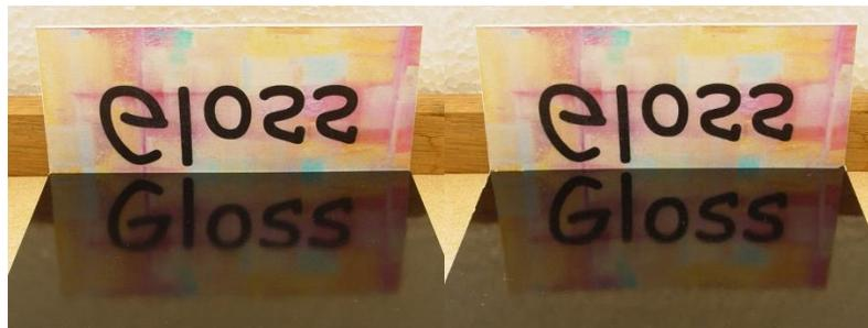
Figure 2.3 - Echantillon NCS 6 (76 GU, à gauche) et 7 (91 GU, à droite), utilisé pour l'étude.
