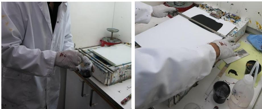
Figure 3.7 – Processus d'application du revêtement sur la surface d'intérêt (ici sur un support papier, mais le processus est le même pour les substrats en verre – images fournies par NCS).
