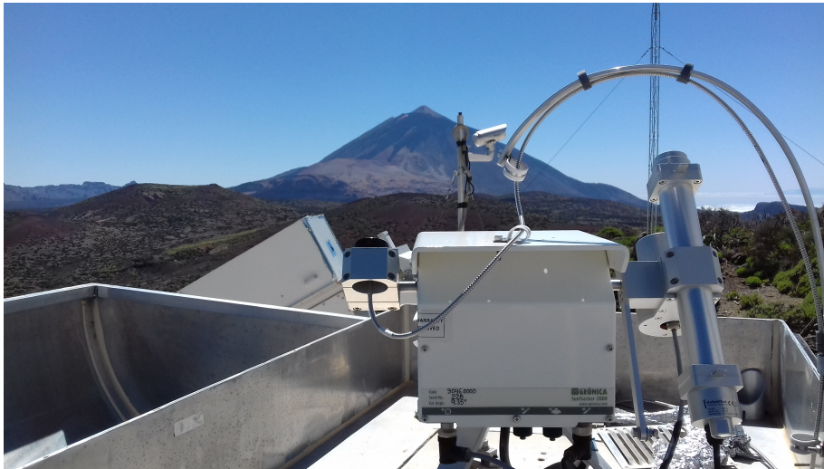
FIGURE 5.6 – Entrée de la fibre optique conduisant la lumière solaire sur le spectrographe.
