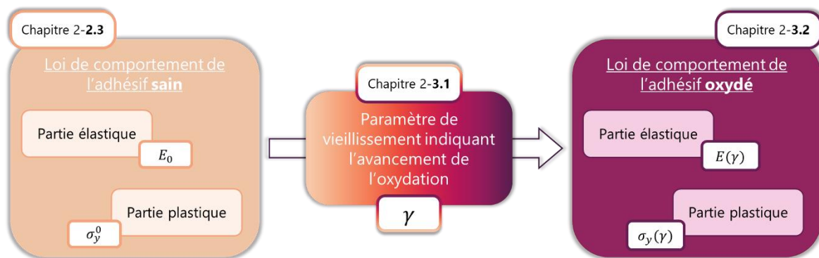
Figure 2-25. Schématisation de la stratégie suivie pour décrire le comportement de l'adhésif vieilli par thermo-oxydation
