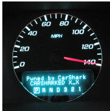
FIGURE 1.4 – Tableau de bord affichant une vitesse erronée ainsi qu’un message personnalisé (issu de [Koscher 2010])
