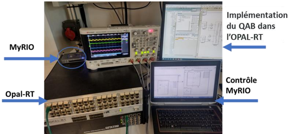
Figure 3-33 - Banc d'essai représentant la schématisation de la Figure 3-32
