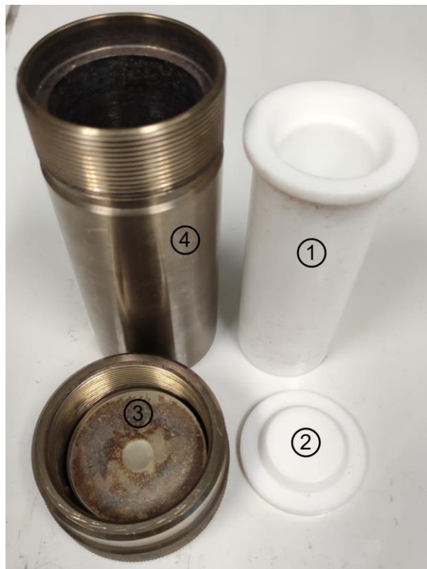
Figure 2.3: Bombe Parr composée d'un réacteur ayant un chemisage en Téflon s'insérant dans un étui de serrage métallique.
