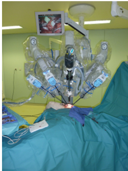
FIGURE 1.17 – Utilisation du robot Da Vinci ® pour la chirurgie endoscopique du plexus brachial. Image issue de [10].
