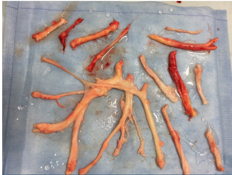
FIGURE 2.2 – Plexus brachial porcine immédiatement après prélèvement, lors de la découpe des éprouvettes.
