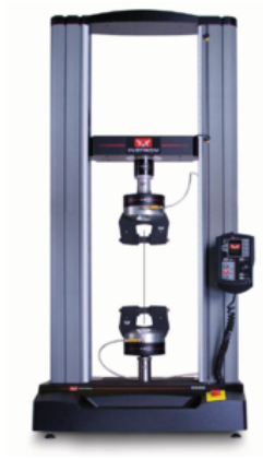
FIGURE 2.4 – Machine d’essais INSTRON ®5969 (moteur électromécanique, cellule 50kN)(INSTRON®, Norwood, MA) de la plateforme IRIS (Institut de Physique Biologique) du laboratoire ICUBE de Strasbourg.
