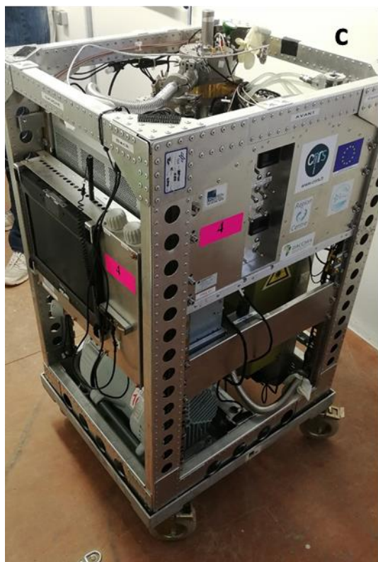
Figure 5-2 a), airmoSCAN XPERT, Chromatotec® ; b), dispositif d'échantillonnage des COVO ; c), spectromètre Infra-Rouge In situ Toute altitude (SPIRIT)
