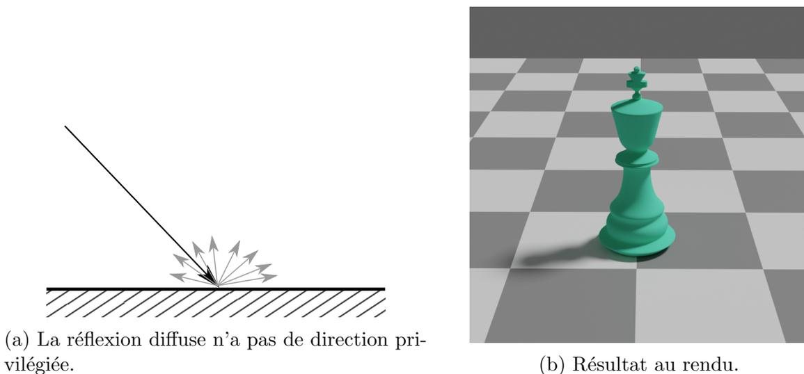
FIGURE 4.4 – Matériau diffus : modèle de Lambert
