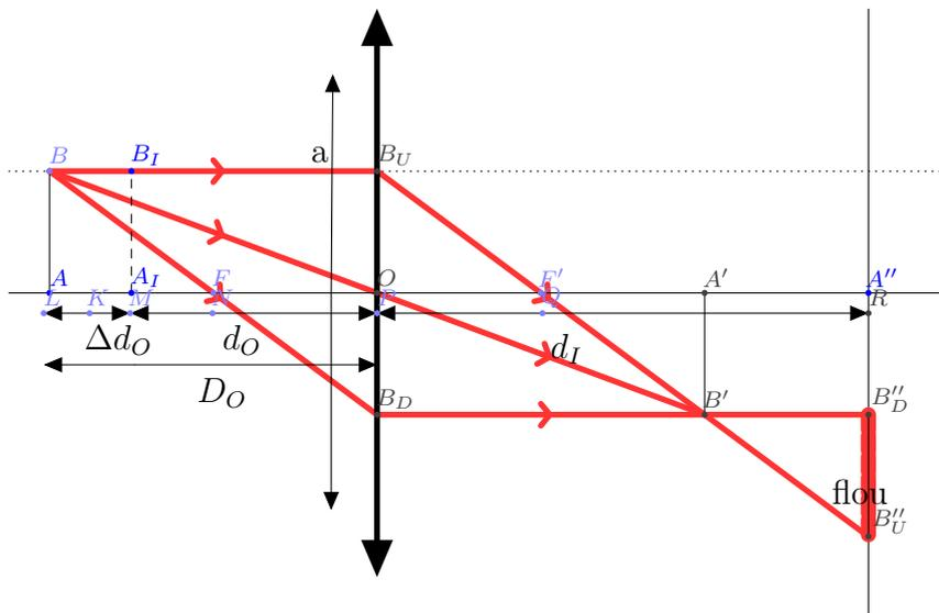
FIGURE 2.16 – Système optique défocalisé.
