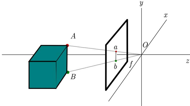
FIGURE 2.3 – Modèle de perspective « plan devant ».
