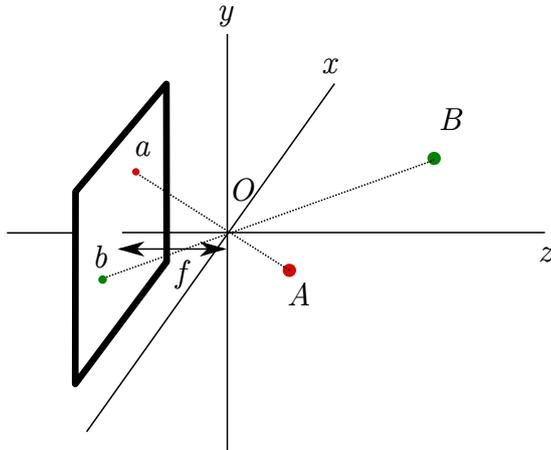
FIGURE 2.2 – Modèle de perspective « plan derrière ».
