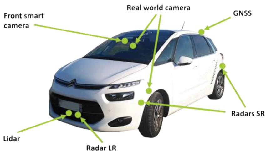
FIGURE 1.15 – Véhicule MOOVE avec capteurs
