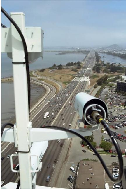
FIGURE 1.12 – Exemple de Camera monté sur un toit et pointant sur un tronçon de l'autoroute I-80 et qui enregistre les trajectoires des véhicules.
