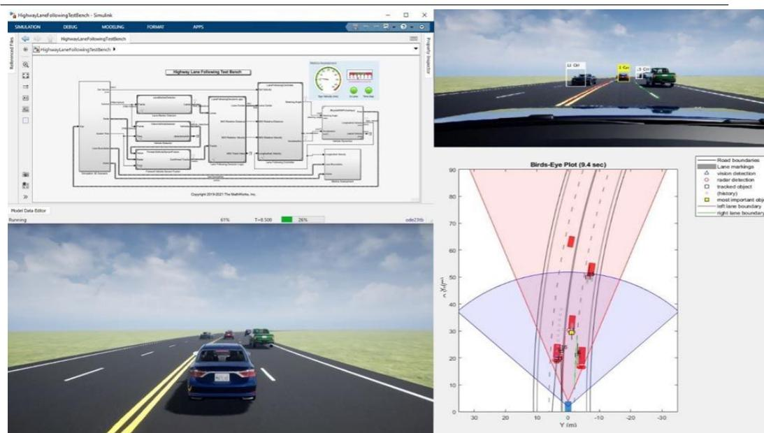
FIGURE 3.20 – Exemple d’interface du Simulateur de conduite de Matlab. Modèle Simulink (haut-gauche). Vue caméra embarqué (haut-droite). Vue extérieure (bas-gauche). Vue aérienne (bas-droit)
