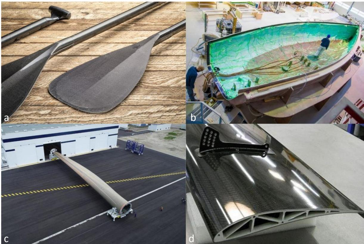
Figure 36 : Images d'objets réalisés à l'aide de procédés de fabrication de matériaux composites : a) rames de compétition en fibres de carbone, b) coque de bateau en fibres de verre réalisée par infusion sous vide, c) pale d'éolienne de 107m en fibres de verre sortie de l'usine de LM Wind Power à Cherbourg, d) aile d'avion en fibres de carbone.
