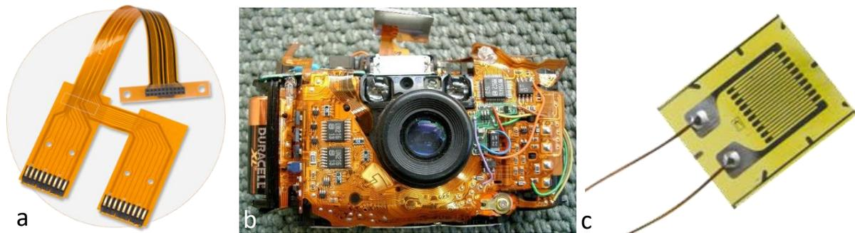
Figure 4 : Applications de l'électronique flexible : a) interconnexions flexibles (PCB), b) appareil photo permettant de montrer le gain d'espace en 3D, c) jauge de déformation métallique sur substrat flexible de kapton.
