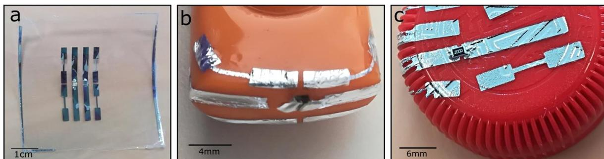
Figure 102 : Images : a) d'une résistance et d'une led intégrées sur des pistes en aluminium réalisées sur film de PVA, b) transfert selon le sens (1) sur un objet, induisant une rupture à cause de la taille du CMS, c) transfert selon le sens (2).
