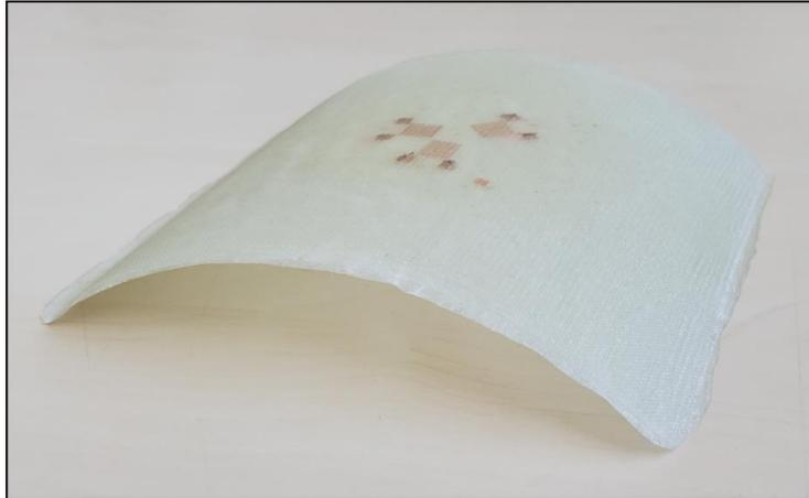
Figure 72 : Image de pièce composite 3D instrumentée de jauges de contraintes métalliques en rosette.
