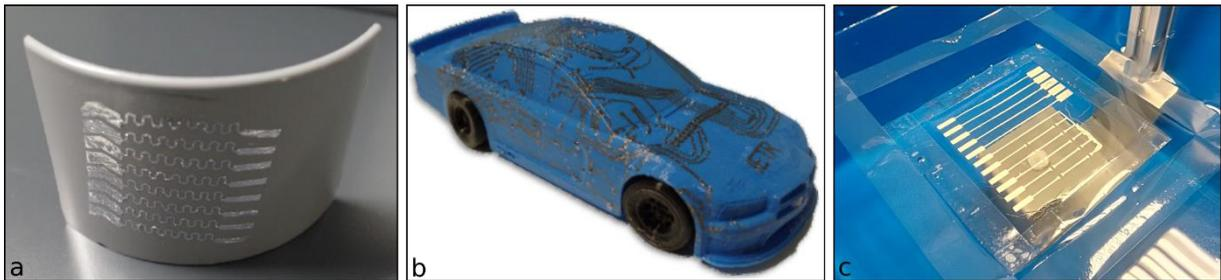
Figure 100 : Images de report de motifs métalliques réalisés à l'IETR sur substrat PVA par : a) *shadow masking*, b) inkjet printing. c) Motifs en encre d'argent réalisés par sérigraphie flottant à la surface de l'eau après dissolution du PVA.
