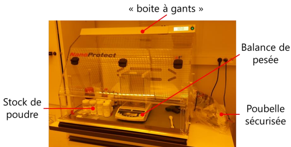
Figure 16 : Poste de pesé sécurisé pour les poudres nanométriques
