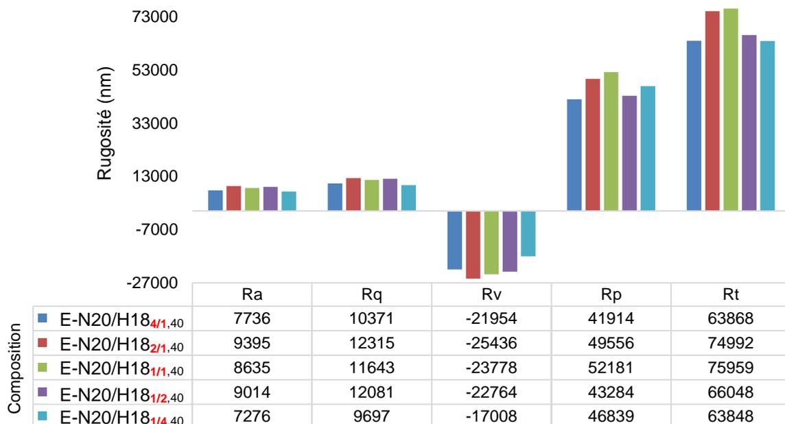
Figure 154- Profils de rugosité de revêtements photopolymérisés (365nm-LED-580mW/cm<sup>2</sup>-3min) : effet du ratio entre silice hydrophile : silice hydrophobe (E-H18/N20<sub>x/1,40</sub>) - Spray coating- Buse 0,5cm- 2 bars
