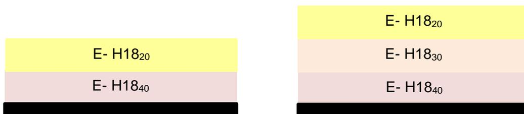
Figure 139- Mise en œuvre de divers revêtements photopolymérisés (365nm-LED-580mW/cm<sup>2</sup>-3min) à gradient de composition - Spray coating- Buse 0,5cm- 2 bars
