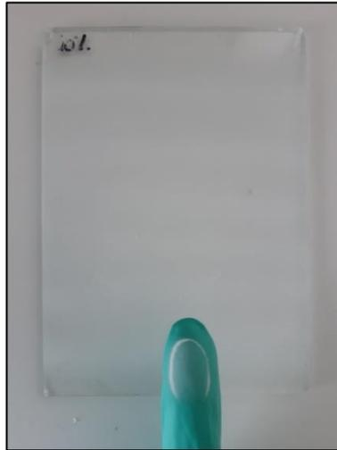
Figure 134- Preuve de la faible résistance à l'abrasion des revêtements photopolymérisés (365nm-LED-580mW/cm<sup>2</sup>-3min) - E-H18<sub>30</sub> - Spray coating- Buse 0,5cm- 2 bars
