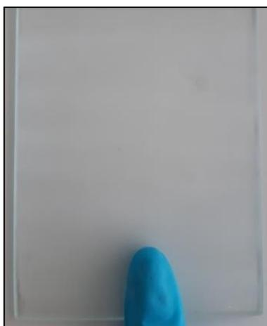
Figure 163- Elimination des résidus d'abrasion d'un revêtement photopolymérisé (365nm-LED-580mW/cm<sup>2</sup>-3min) à base de particules de silice hydrophile N20 greffée -E-N20<sub>g,40</sub> - Spray coating- Buse 0,5cm- 2 bars
