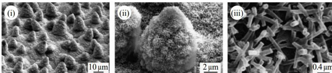
Figure 15- Observation par microscopie (MEB) de la structure multi-échelles d'une feuille de lotus<sup>27</sup>
