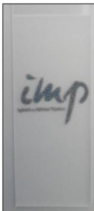
Figure 127- Aspect visuel d'un revêtement photopolymérisé (365nm-LED-580mW/cm<sup>2</sup>-3min) et chargé de particules de silice hydrophobe H18 (E-H18<sub>40</sub>) - Spray coating -Buse 0,5cm- 2 bars
