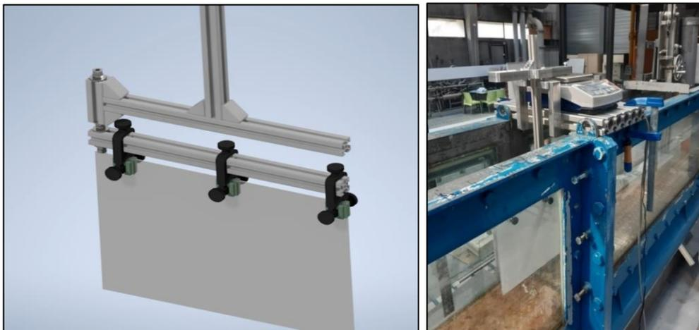
Figure 202 – Montage expérimental de mesure du coefficient de la traînée de frottement
