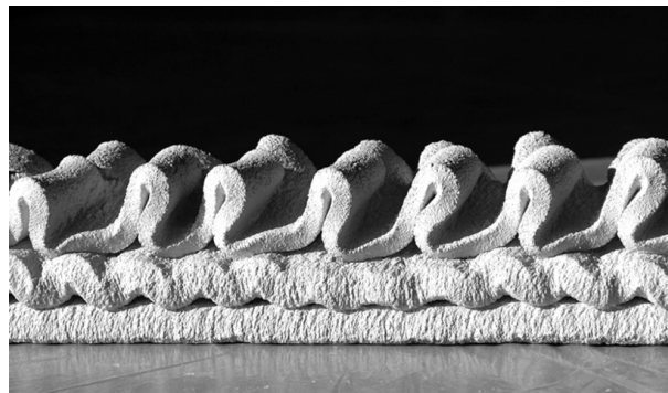
FIGURE 1.3 – Impression d'un ciment par une buse rectangulaire (TU Eindhoven). La quantité de matériau augmente de la couche basse à la couche haute. Lorsque trop de matière est extrudée, le dépôt forme des motifs
