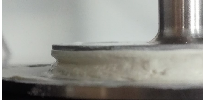
FIGURE 2.10 – Creusement du kaolin dans la géométrie plan-plan après un fort cisaillement
