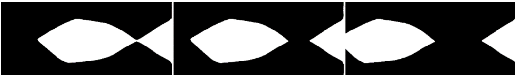
FIGURE B.1 – 3 images à la suite pour repérer la cassure. La première ne contient qu'un bloc blanc. La deuxième et la troisième en contiennent deux
