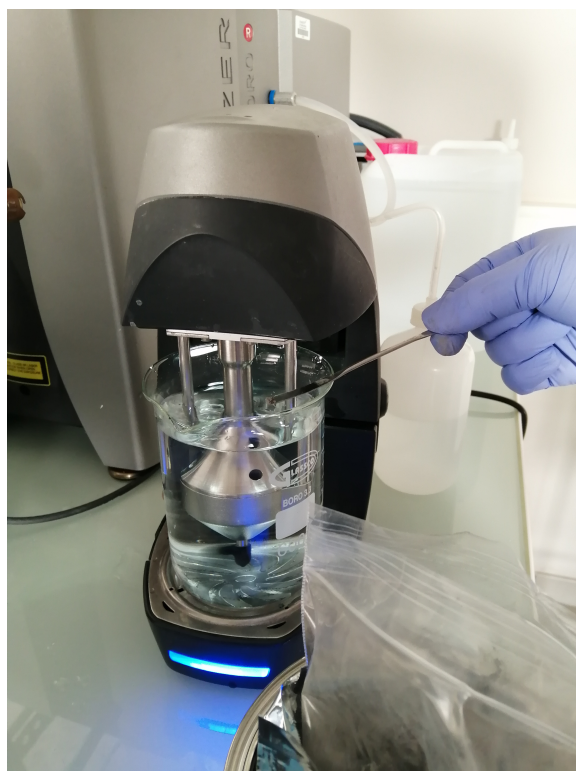
FIGURE 3.41 – Introduction de la poudre dans le module HYDRO EV .
