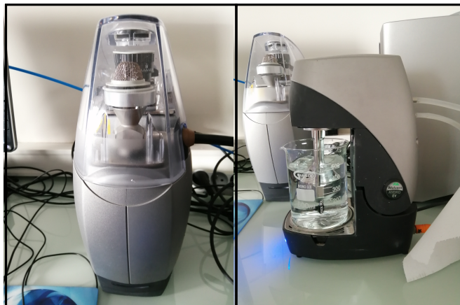
FIGURE 3.40 – Unités de dispersion Aero M (à gauche) et Hydro EV (à droite).
