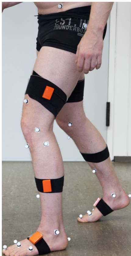
FIGURE 1.2 – IMUs pour extraire les informations de mouvement et de rotation (BLESER et al., 2017).
