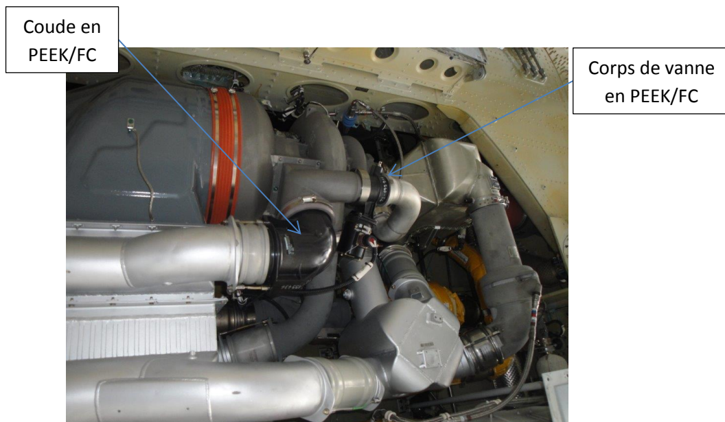
Figure 2 : Pack de climatisation installé sur avion
