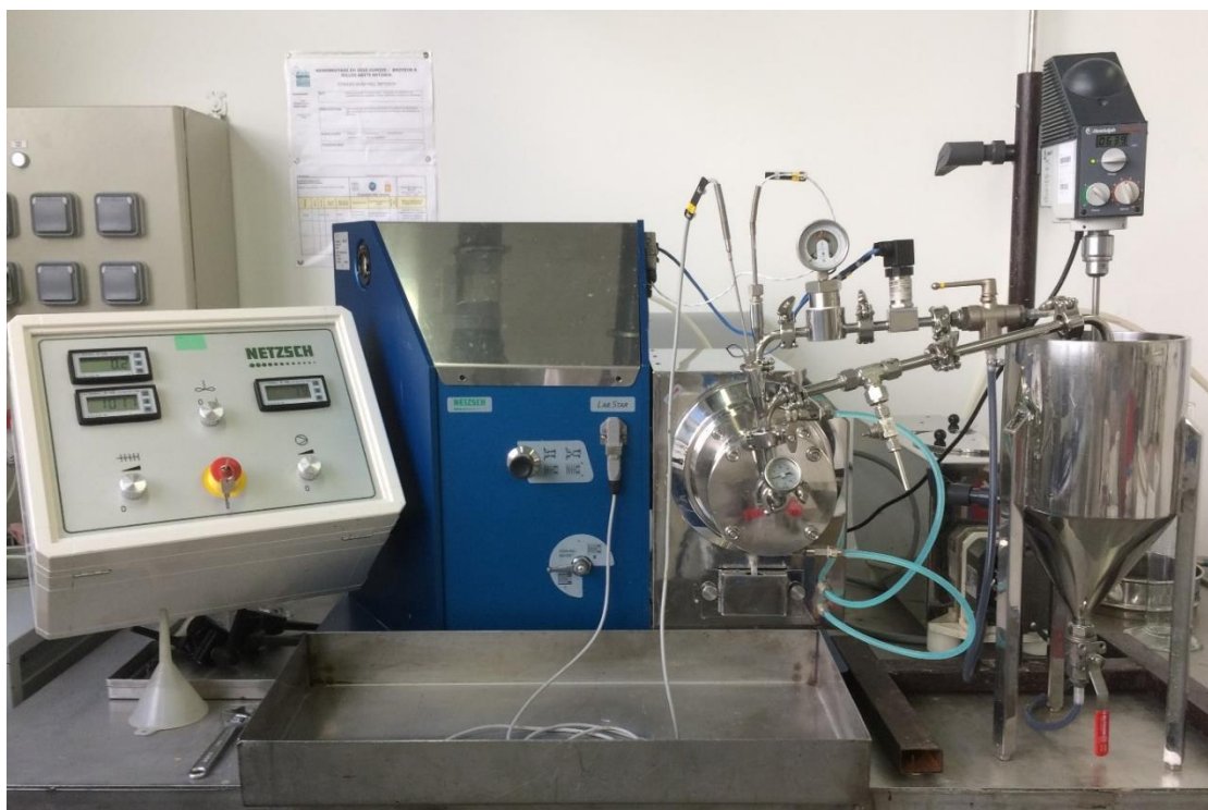
Figure 4-1. LabStar industrial stirred bead mill (NETZSCH)
