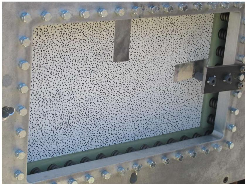
Figure 74 - Vue du mouchetis réalisé sur la face arrière de l'évaluateur en composite.
