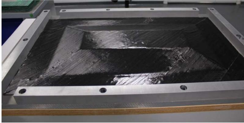
**Figure 47 - Plis de la face avant de l'ETMI drapé dans le fond du moule.**
