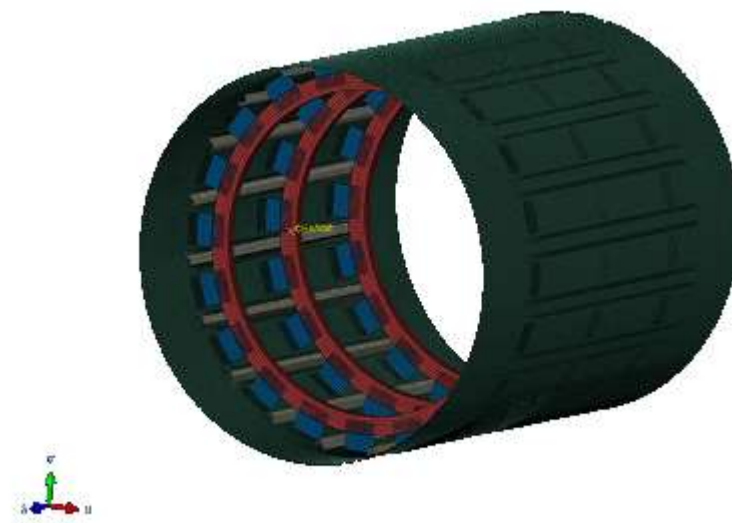
Figure 17 - Maillage du fuselage via Abaqus avec représentation de la peau (en vert) et les cadres (en rouge), les lisses (en gris) et les clips (en bleu).
