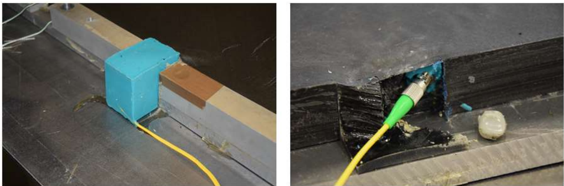
Figure 61 - A gauche : vue du bloc de silicone où le connecteur est moulé avant cuisson. A droite : vue du connecteur après cuisson une fois le bloc enlevé.
