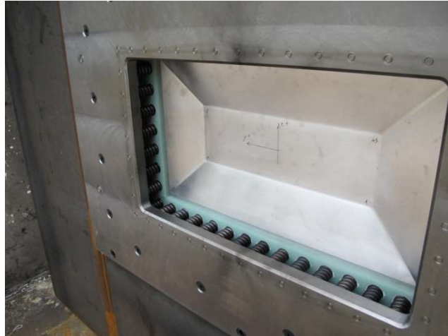
Figure 84 – A gauche, vue en coupe de l'évaluateur dans son support avec le positionnement des ressorts dans leurs barreaux en fibre de verre (orange). A droite, vue des ressorts mis en place sur l'évaluateur en aluminium.
