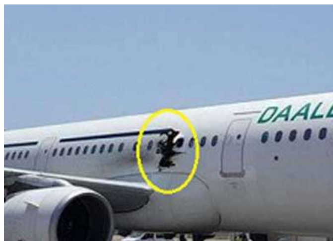
Figure 2 - Images des dégâts provoqués par l'explosion d'une bombe sur le fuselage du Vol 3159 Daallo Airlines.
