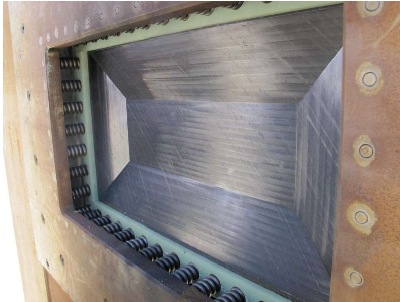
Figure 117 - Vue de l'évaluateur en composite suite à un essai avec des stries à 45° visibles à l'œil nu.
