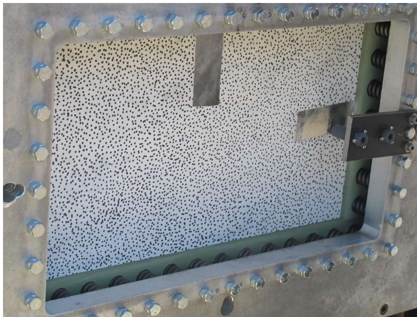
Figure 74 - Vue du mouchetis réalisé sur la face arrière de l'évaluateur en composite.
