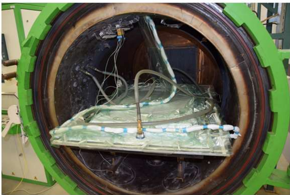
Figure 51 - Vue de l'ETMI A-2 dans l'autoclave avant cuisson.
