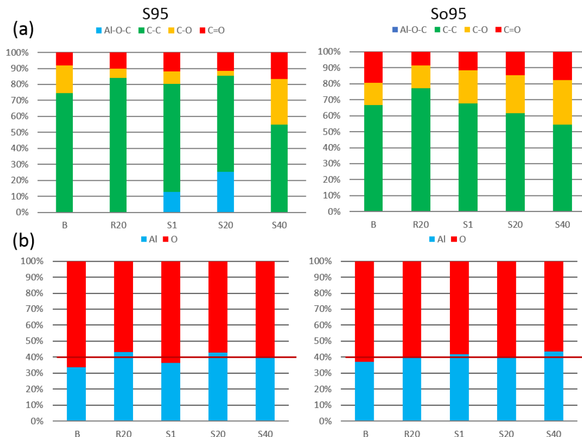
Figure 69: (a) Composition du carbone par type de liaison chimique et (b) concentration en aluminium et oxygène dans l'alumine (le trait rouge représente un mélange stœchiométrique Al_2O_3 )
