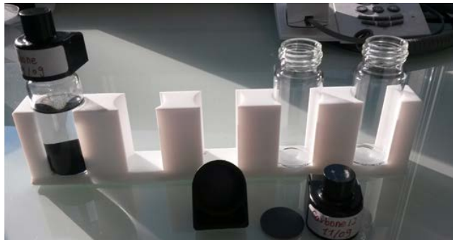
Figure 1 : Fiole et bouchon utilisés pour le Turbiscan
