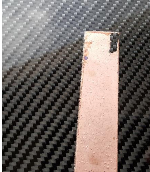
Figure 39. Image d'un composite carbone revêtu de résine époxyde non métallisé (partie noire) puis métallisé par cuivre electroless (partie cuivrée).
