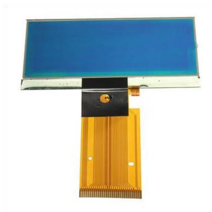
**Figure 60. Image de nappe électrique flexible pour écran d'ordinateur.**
