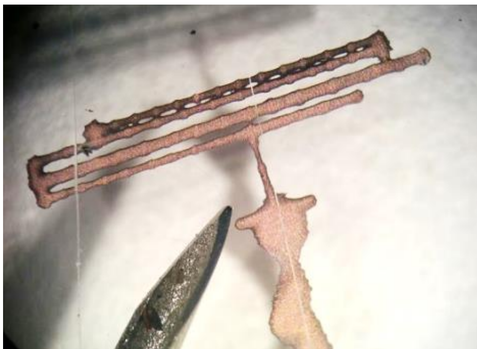
Figure 49. Image obtenue après greffage au LASER puis métallisation sur un film de PET, observé à la binoculaire.
