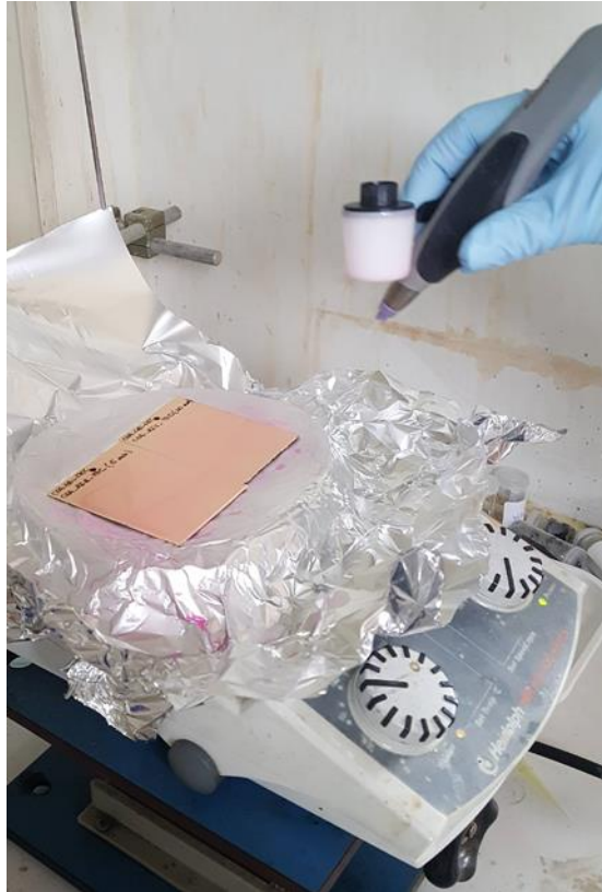
Figure 64. Dépôt au spray du primaire de métallisation sur composite de l'Industriel A.
