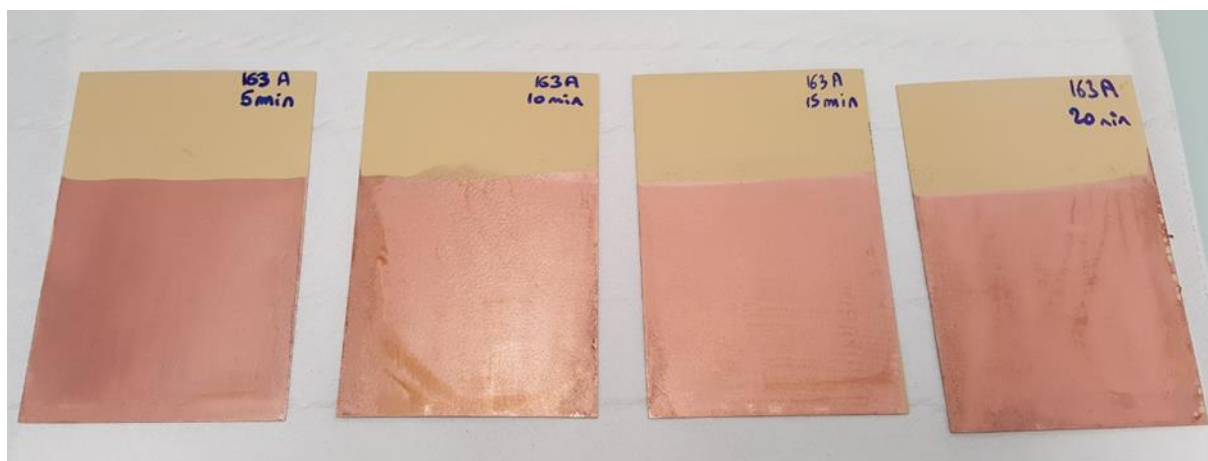
Figure 66. Métallisation cuivre des composites verre/époxy par electroless pendant 5; 10; 15 et 20 minutes.
