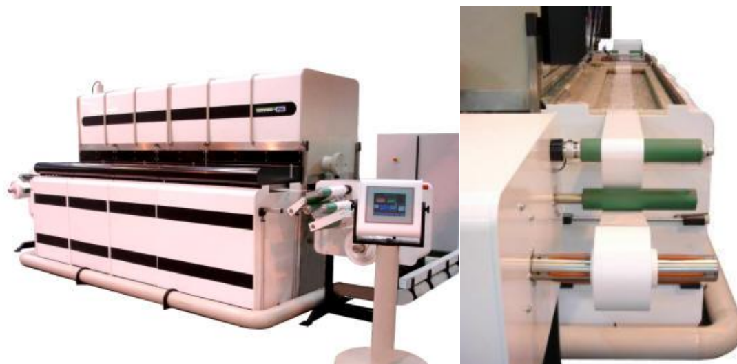
Figure 79. Bain de métallisation en R2R s .
