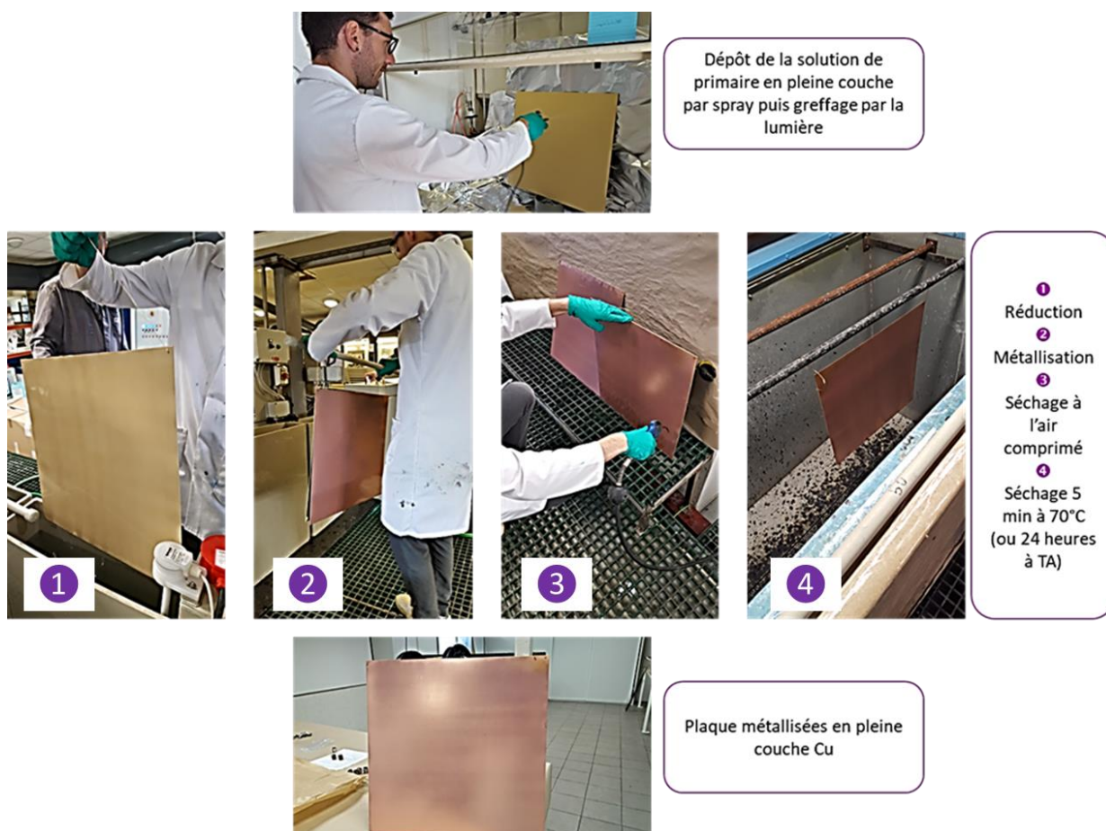
Figure 68. Métallisation grande échelle des plaques Carbone/époxy et verre/époxy chez KERBIRIO.
