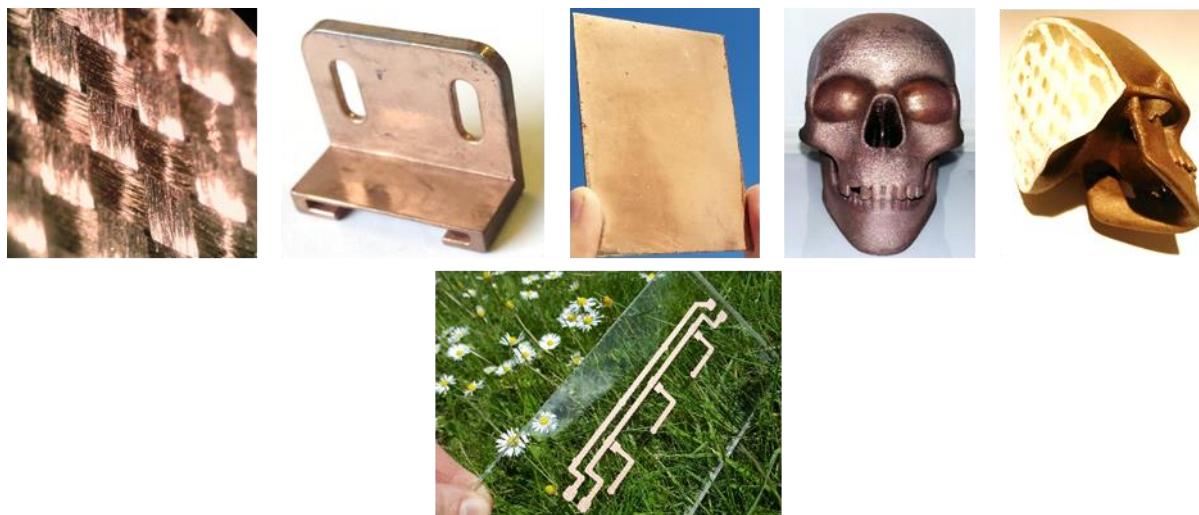
Figure 62. Différents substrats métallisés autres que des substrats flexibles, de gauche à droite on retrouve des fibres de Kevlar, un substrat imprimé 3D en ABS, un composite carbone recouvert de résine polyuréthane, un objet 3D en polyamide et un circuit imprimé sur PMMA.
