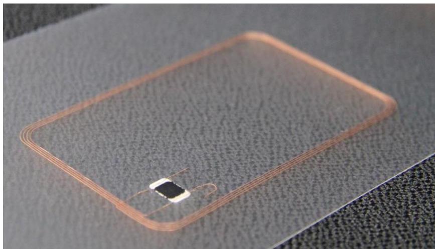
Figure 3. Images d'antennes RFID bobiné à plat par du fil de cuivre c .
