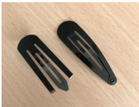
Figure 6: Barrettes à cheveux, un mécanisme bistable obtenu par précontrainte de deux barres en les rapprochant entre elles
